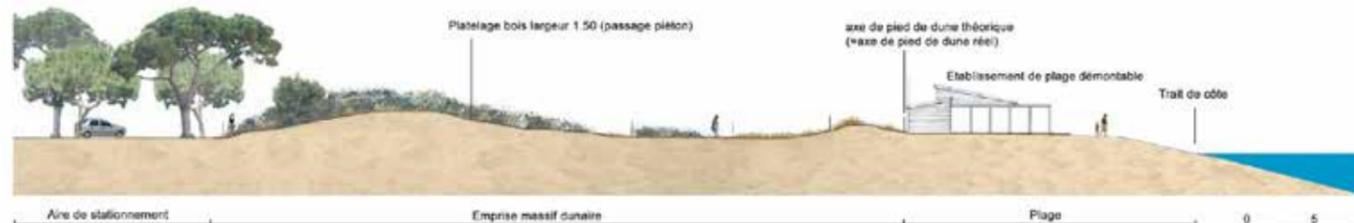
Fig 128 : Coupe de principe sur les établissements de plage démontables
