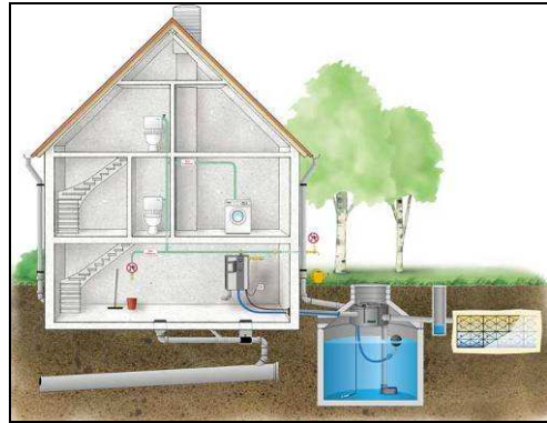
Récupération des eaux pluviales de toitures pour stockage + réutilisation dans logement (lave linge, WC) + arrosage
